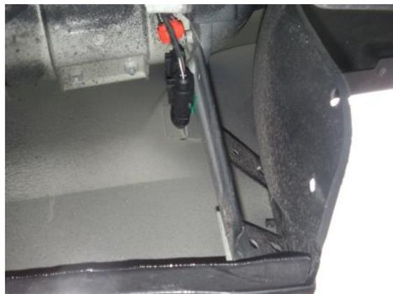
**11)** Soudez le faisceau de câble au système électrique du véhicule. Vous pouvez utiliser les verrous scotch fournis, mais il est recommandé de souder. Veuillez noter que nous conseillons de recouvrir toute connexion d'un matériau isolant approprié et sécurisé.
