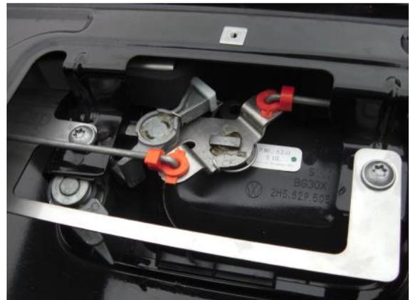
**7)** Connectez le faisceau de câble à l'actionneur:
