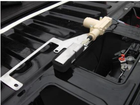
**6)** Installez la plaque de base et le kit d'actionneur, maintenez-les en place en replaçant les vis retirées au préalable
