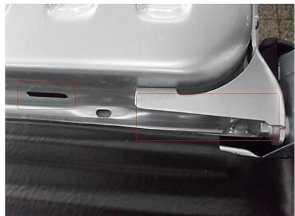
**9)** Faites passer le câble à travers le pare-chocs, en perçant un petit trou ou en faisant passer la câbles par un espace sur le côté gauche du pare-chocs. Utilisez le tube flexible plastique fourni pour protéger le câble
