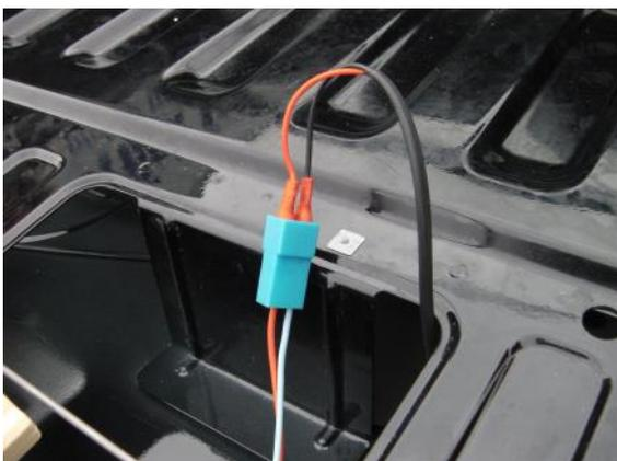
**8)** Faites sortir les câbles du hayon, et attachez-les à l'aide des serres-câbles fournis. Faites-les sortir du côté où se trouve le bouchon du réservoir de carburant
